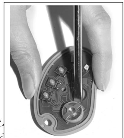
*Attention : pendant le remplacement des piles, ne pas toucher le circuit imprimé. Toute détérioration du circuit imprimé n'est pas garantie par le fabricant.*
